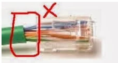
Gambar 3.18 Contoh pemasangan yang buruk
