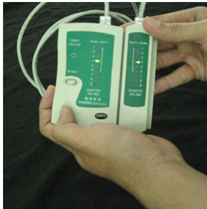
Gambar 3.19 Tes Hasil Pemasangan Konektor
