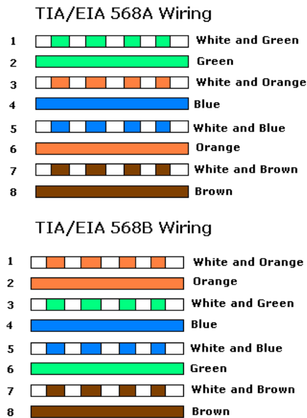
Gambar 3.4 Urutan Warna Kabel TP
