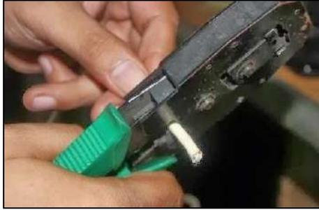
Gambar 94. Pengupasan Kabel dengan *Crimper*
