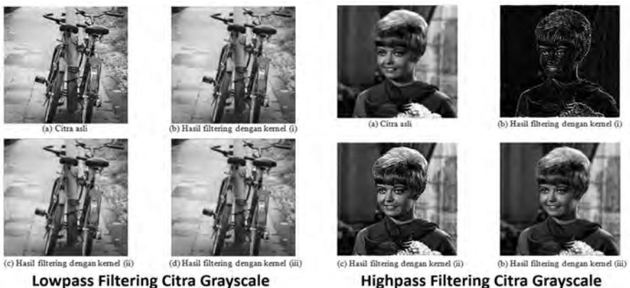
Gambar 6.3. Lowpass dan Highpass Filtering pada Citra Grayscale
