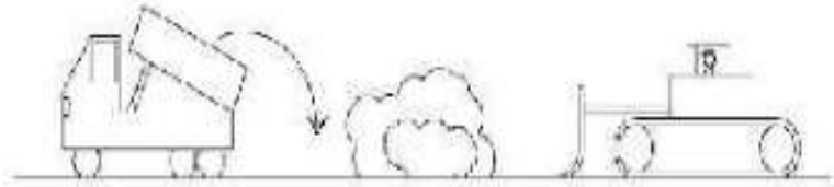
Gambar 1.17 Penyebaran Bulldozer dan Pemadatan Vibrator Roller
