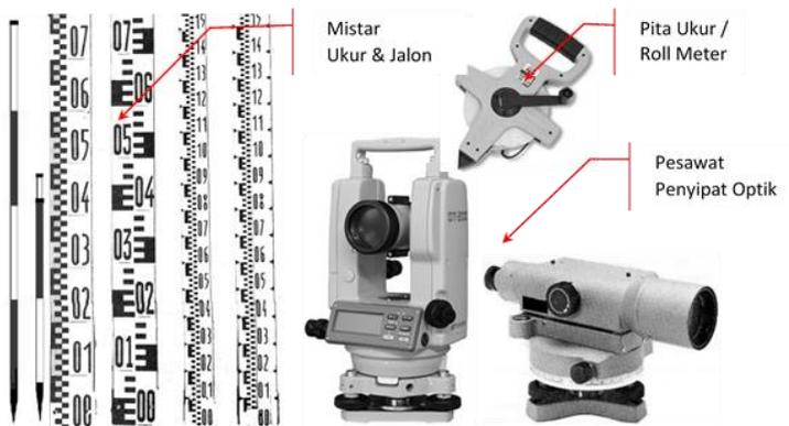
Gambar 2.2. Alat Pengukur Jarak
