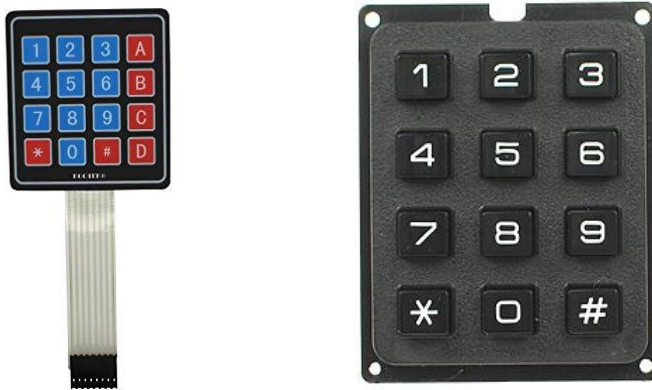
Gambar 7.1 Tampilan fisik 2 jenis keypad yang biasa Digunakan untuk project mahasiswa
