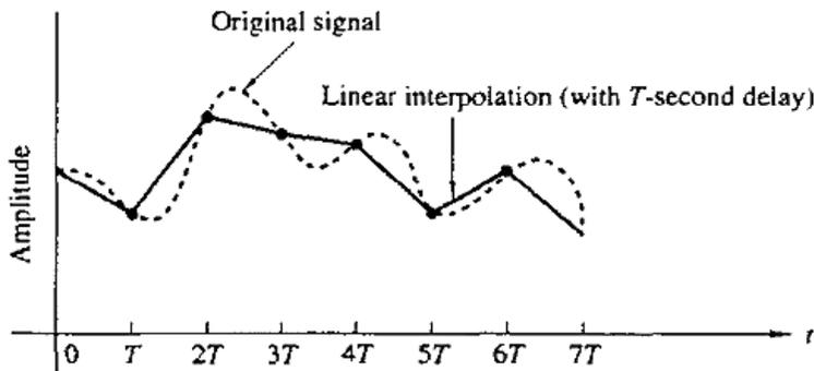
**Gambar 3.35 Interpolasi Linear dengan Waktu Tunda T Detik**
