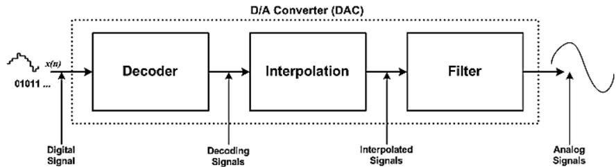
**Gambar 3.33 Blok Diagram Dasar DAC**
