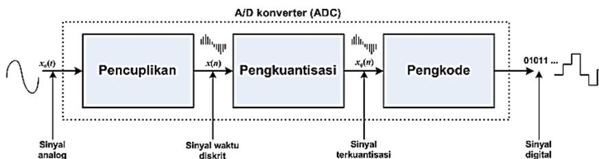
Gambar 3.2 Blok diagram dasar ADC
