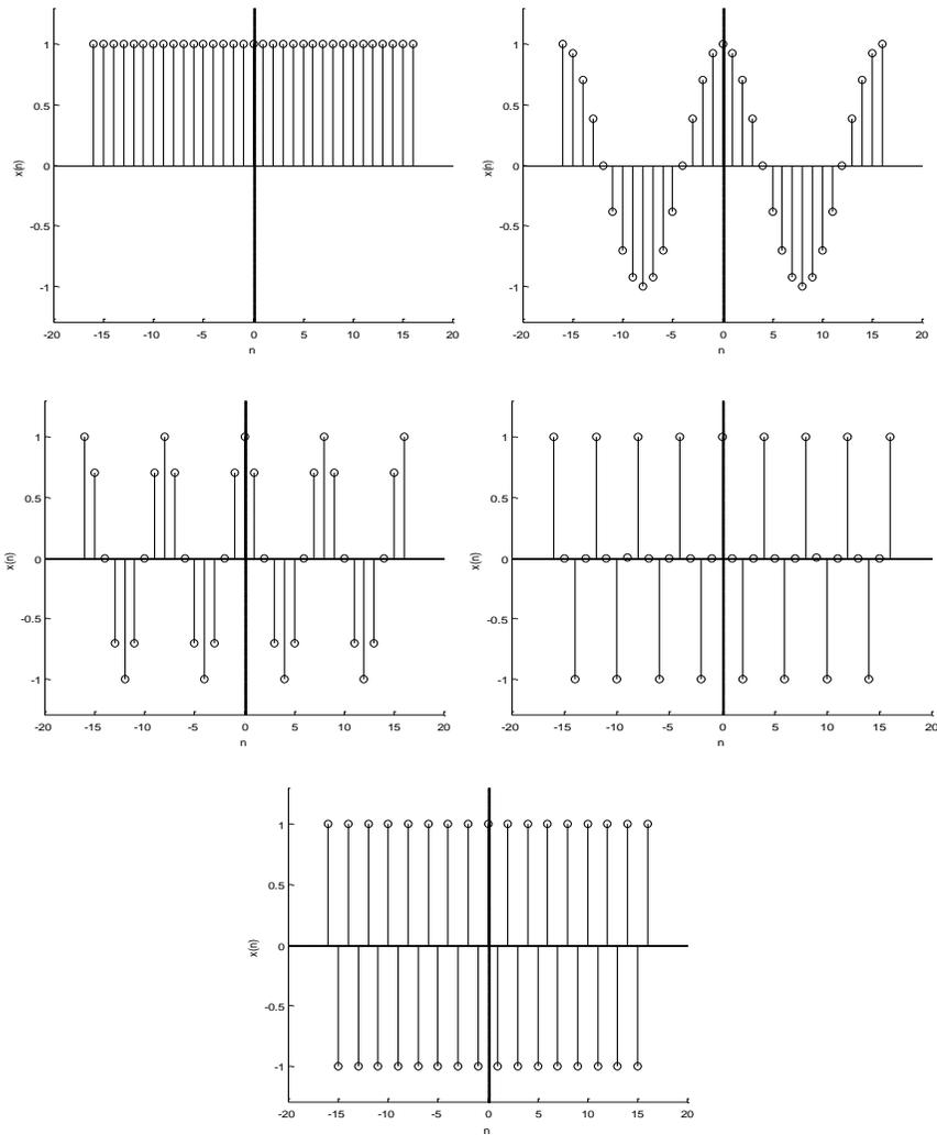
**Gambar 2.9 Sinyal  $x(n) = \cos(\omega_a n)$  dengan  $\omega = 0, \pi/8, \pi/4, \pi/2, \pi$**
