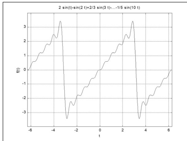
**Gambar 6.8.c Simulasi Gelombang Berulang untuk Gelombang Gigi Gergaji Gambar 6.6 Harmonisa ke-10**
