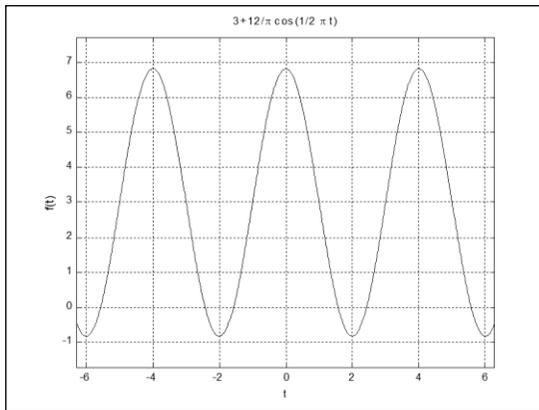
**Gambar 6.4.a Simulasi Gelombang Berulang untuk Gelombang Pulsa Segi Empat Gambar 6.2 pada harmonisa ke-1**
