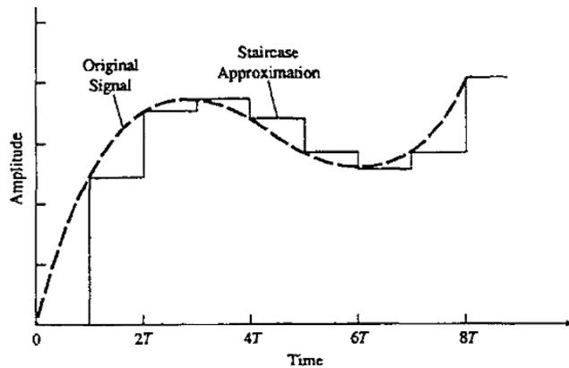
**Gambar 3.34 Konversi Digital ke Analog dengan Metode Zero Order Hold**
