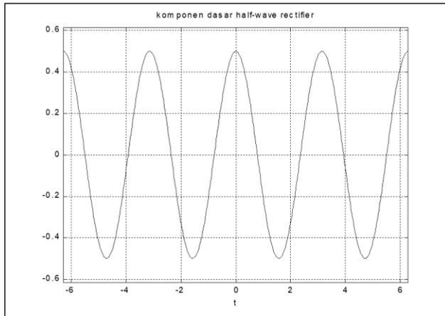
**Gambar 6.11 Simulasi Komponen Gelombang Dasar untuk *Half-wave rectifier* Gambar 6.10**
