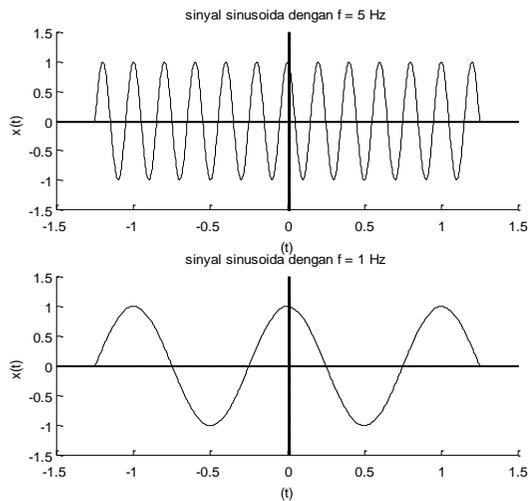
**Gambar 2.4 (atas) Sinyal  $x_a(t) = A\cos\omega_a t$  dengan  $f = 5$  Hz
