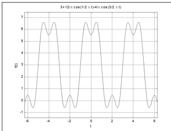
**Gambar 6.4.b Simulasi Gelombang Berulang untuk Gelombang Pulsa Segi Empat Gambar 6.2 pada Harmonisa ke-3**
