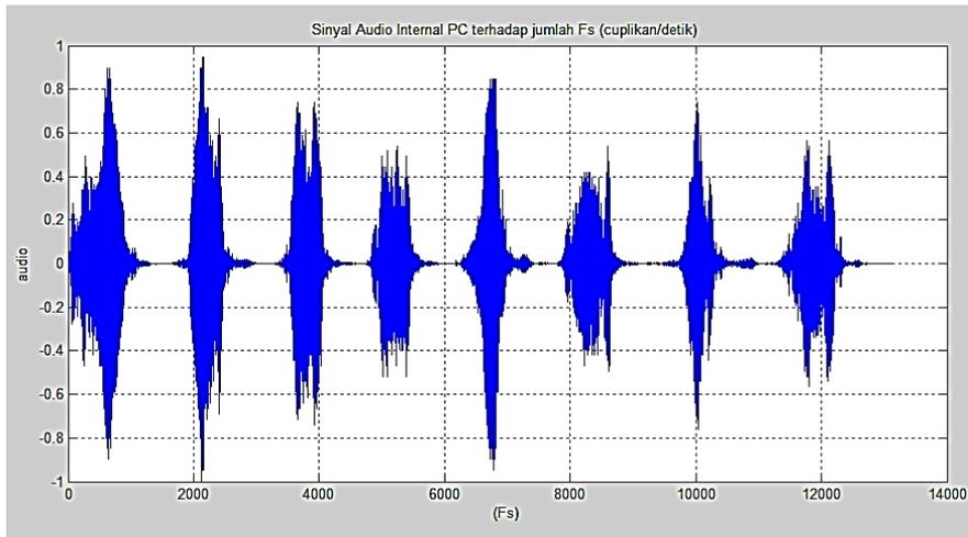
**Gambar 1.2 Sinyal Audio Internal PC dengan Frekuensi Sampling 8000 cuplikan/detik**
