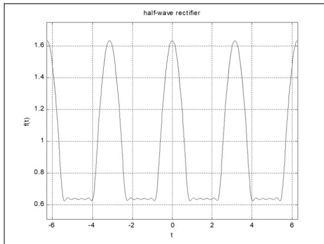
**Gambar 6.12.c Simulasi Gelombang Berulang untuk *Half-Wave Rectified* Gambar 6.10 Harmonisa ke-10**
