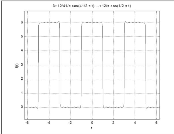
**Gambar 6.4.e Simulasi Gelombang Berulang untuk Gelombang Pulsa Segi Empat Gambar 6.2 pada Harmonisa ke-150**
