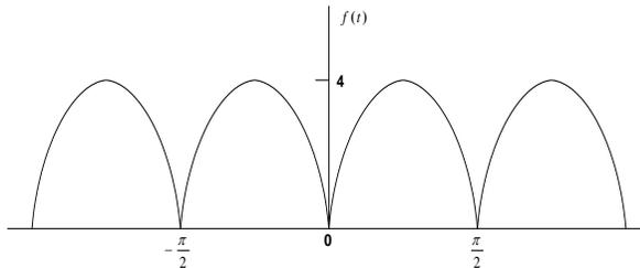
**Gambar 6.14 Sinusoida yang disearahkan *full-wave-rectified* untuk soal no.2**
