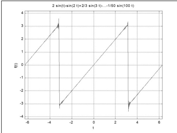
**Gambar 6.8.d Simulasi Gelombang Berulang untuk Gelombang Gigi Gergaji Gambar 6.6 Harmonisa ke-100**
