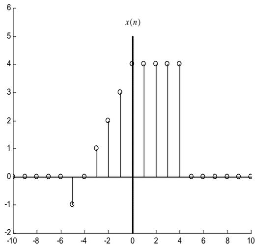
**Gambar 4.7** Ilustrasi Sinyal Diskrit  $x(n)$  untuk Contoh 4.1
