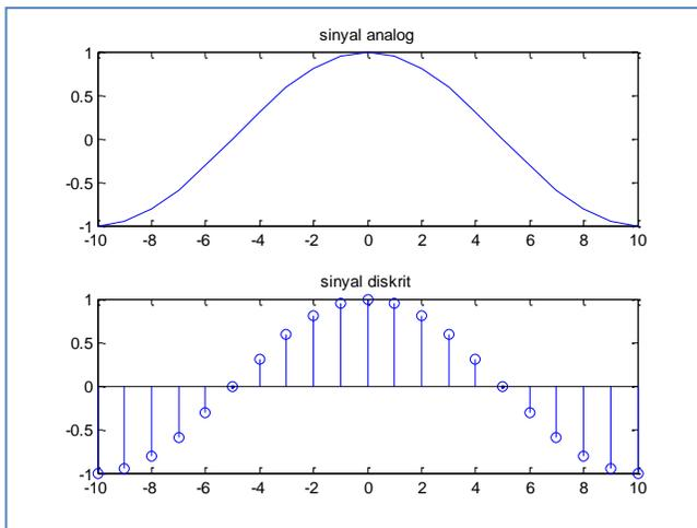
**Gambar 1.8 Sinyal Analog dan Sinyal Diskrit yang Berasal dari Pencuplikan Sinyal Analog**
