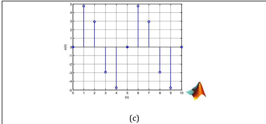
**Gambar 3.4 (a) Sinyal Sinusoida  $x_a(t) = 5\sin(\omega_a t)$  (b) Sinyal Sinusoida  $x_a(t) = 5\sin(\omega_a t)$  dicuplik dengan 10 cuplikan atau 10 sampling per detik (c) Hasil sampling sinyal sinusoida  $x_a(t) = 5\sin(\omega_a t)$  sebanyak 10 cuplikan dalam 1 detik**
