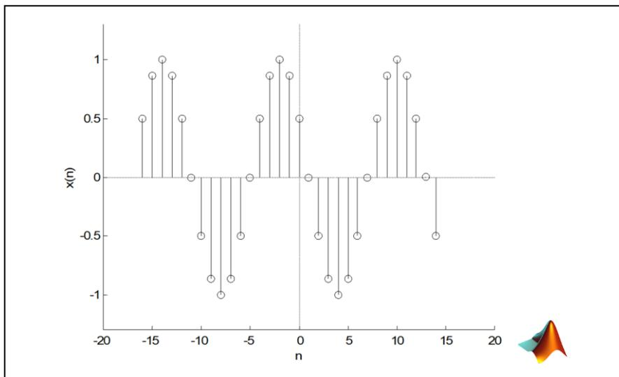
**Gambar 2.5 Contoh Sinyal Sinusoida Waktu Diskrit  $x(n) = \cos(\omega_d n + \theta)$ ,  $\omega_d = \pi/6$ , rad/cuplikan dan  $\theta = \pi/3$  rad**
