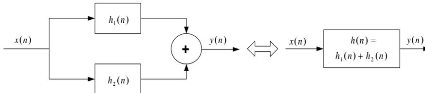
**Gambar 5.10 Interpretasi Sifat Konvolusi Distribusi. Dua Sistem LTI Dihubungkan Secara Paralel dengan Sistem Tunggal dengan  $h(n) = h_1(n) + h_2(n)$**
