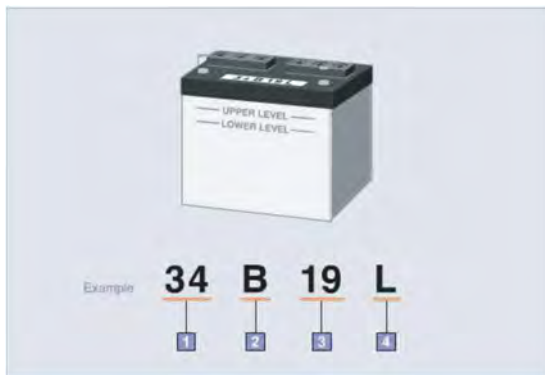
Gambar 7.2. Kode identifikasi baterai
