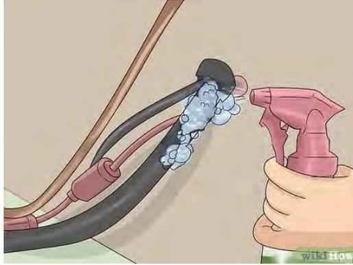
Gambar 43. Tes kebocoran dengan busa (wikihow.com)
